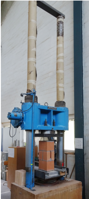
Essai de résistance à la compression des appuis muraux NUVO avec blocs de référence
