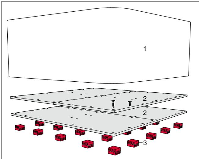
**Isolation à basse fréquence des vibrations avec des supports ponctuels**
